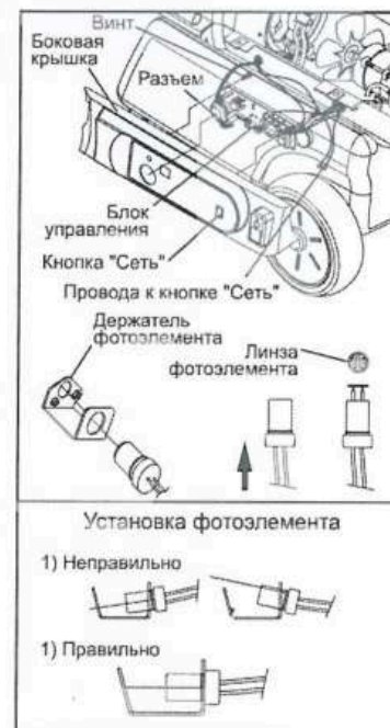
Рис. 18. Замена фотоэлемента
