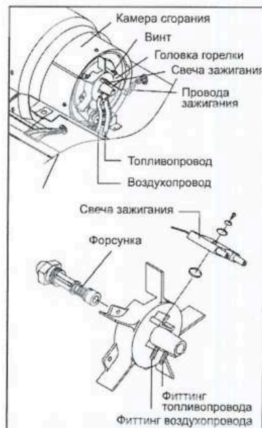
Рис 16. Снятие форсунки
