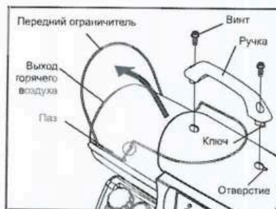
Рис. 6. Установка ручки и переднего ограничителя
