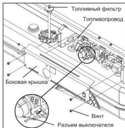
Рис. 14 Замена топливного фильтра
