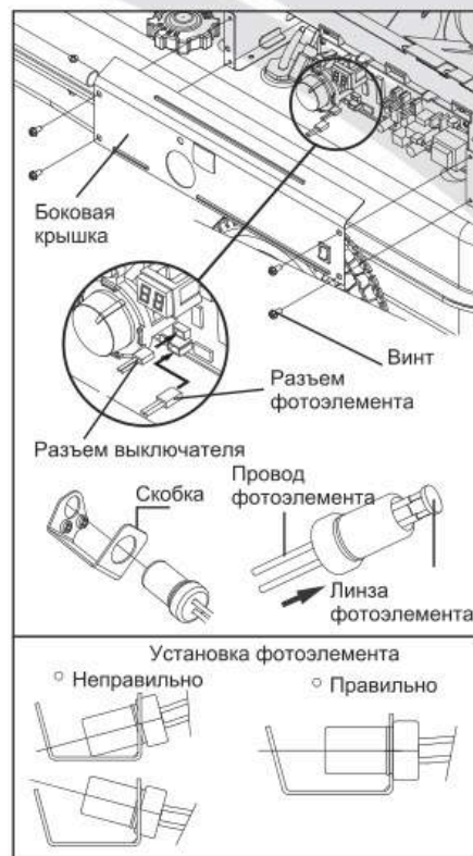
Рис. 13 Замена фотоэлемента
