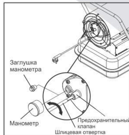
Рис. 15 Регулировка давления воздушного насоса
